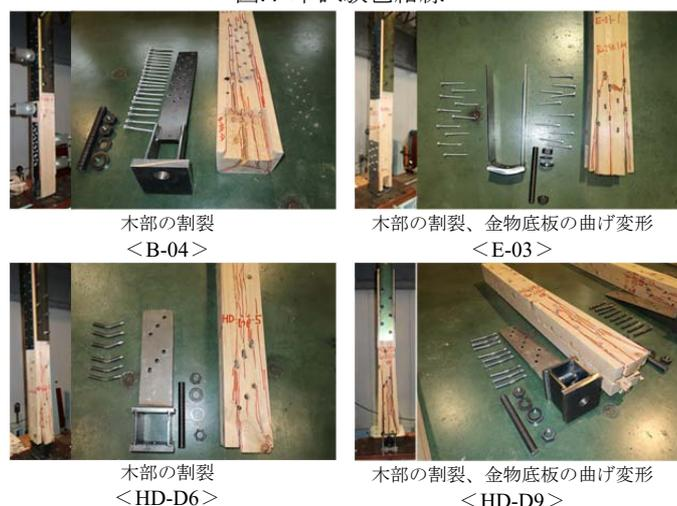
図.5 破壊状況
