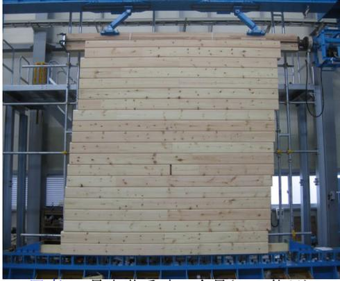
写真1 最大荷重時の全景(3m1 体目)
