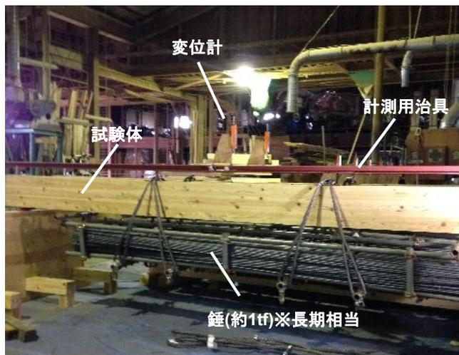
写真 1 実験概要写真
