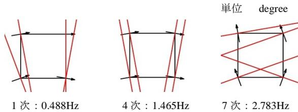
図5 数値モデルの応答解析結果から求めた回転中心図
