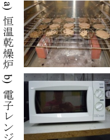
写真 4 土の乾燥装置
