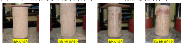
写真1 試験体破壊形状
