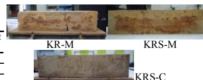
写真3 試験体破壊形状
