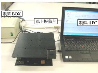
図1 卓上振動台の構成と形状
