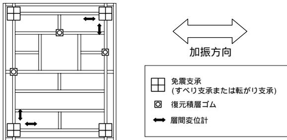
図 4 偏心実験時の装置配置図
