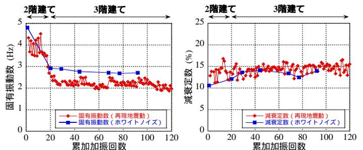
図1 固有振動数の変化
