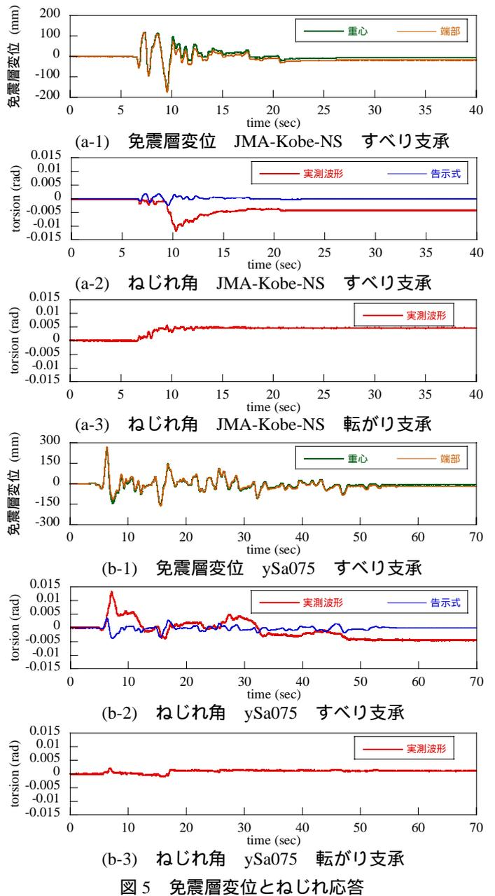
図 5 免震層変位とねじれ応答
